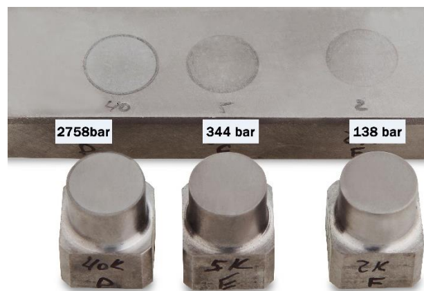
Abb. 2: Untersuchung des Festfress-Verhaltens an Expanite-gehärtetem 1.4404. Keinerlei Kaltverschweißen kann beobachtet werden – nicht einmal bei Anpressdrücken oberhalb der Fließgrenze des Werkstoffs.
