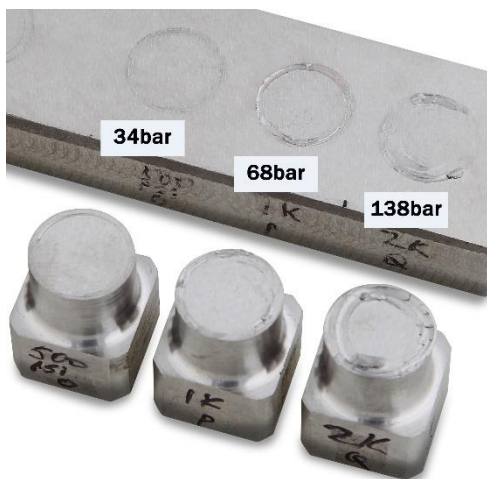
Abb. 1: Untersuchung des Festfress-Verhaltens an unbehandeltem 1.4404 zeigt signifikantes Kaltverschweißen bereits bei relative niedrigen Anpressdrücken.
